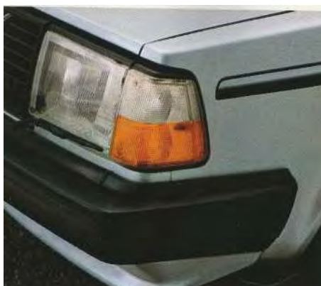
3. Nya lättare stotfångare, som går mer "runt hornen", reducerar totallängden på bilen.
