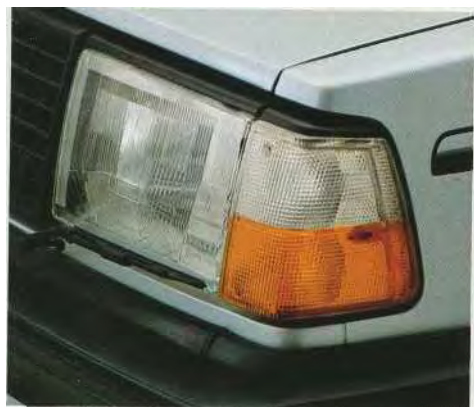
2. Nytt ljusarrangemang med inbyggda korriktungs-, varsel- och parkeringsljus.
