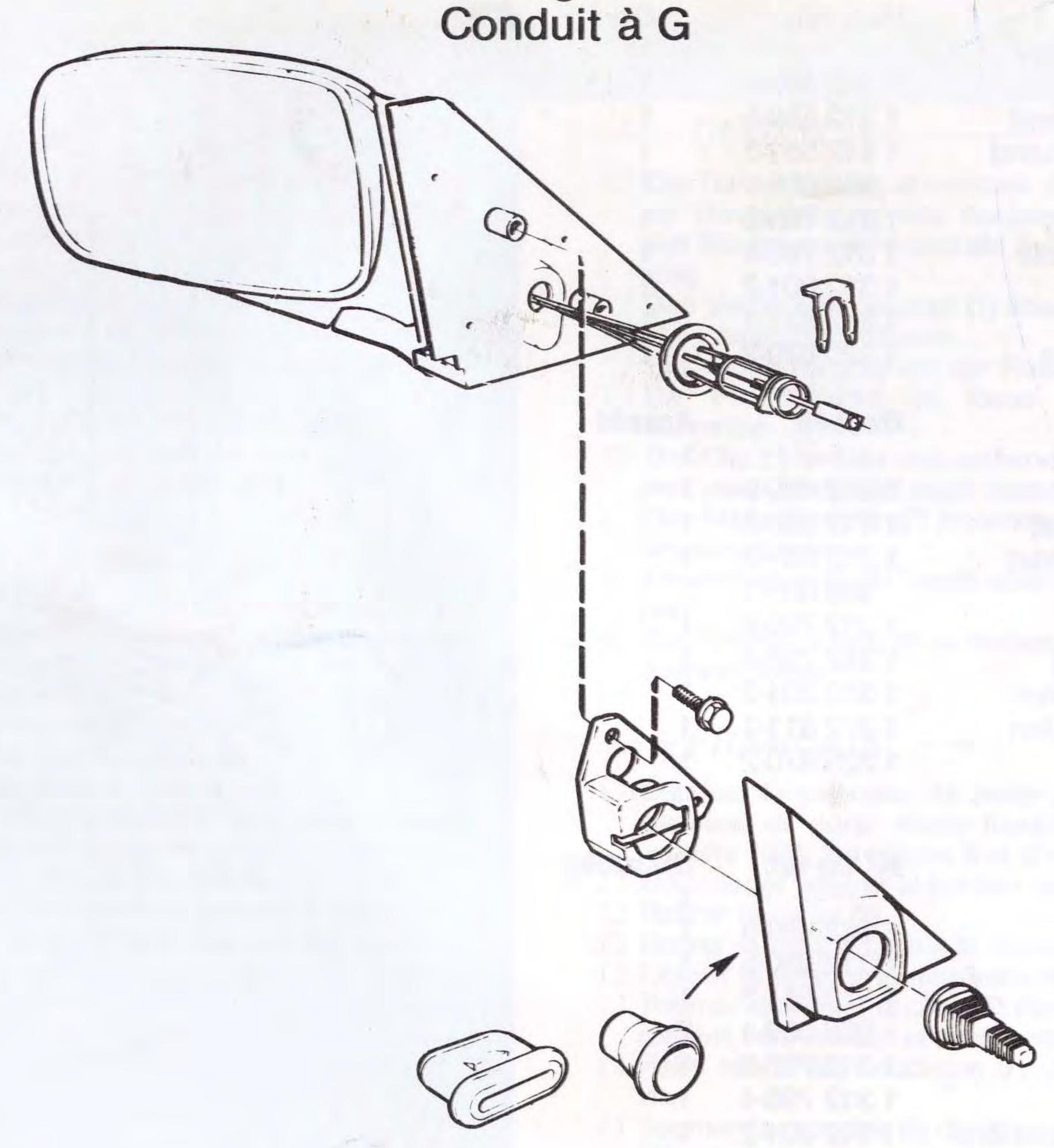
Anvisningen beskriver montering av vänster backspegel. Höger backspegel monteras på motsvarande sätt.
