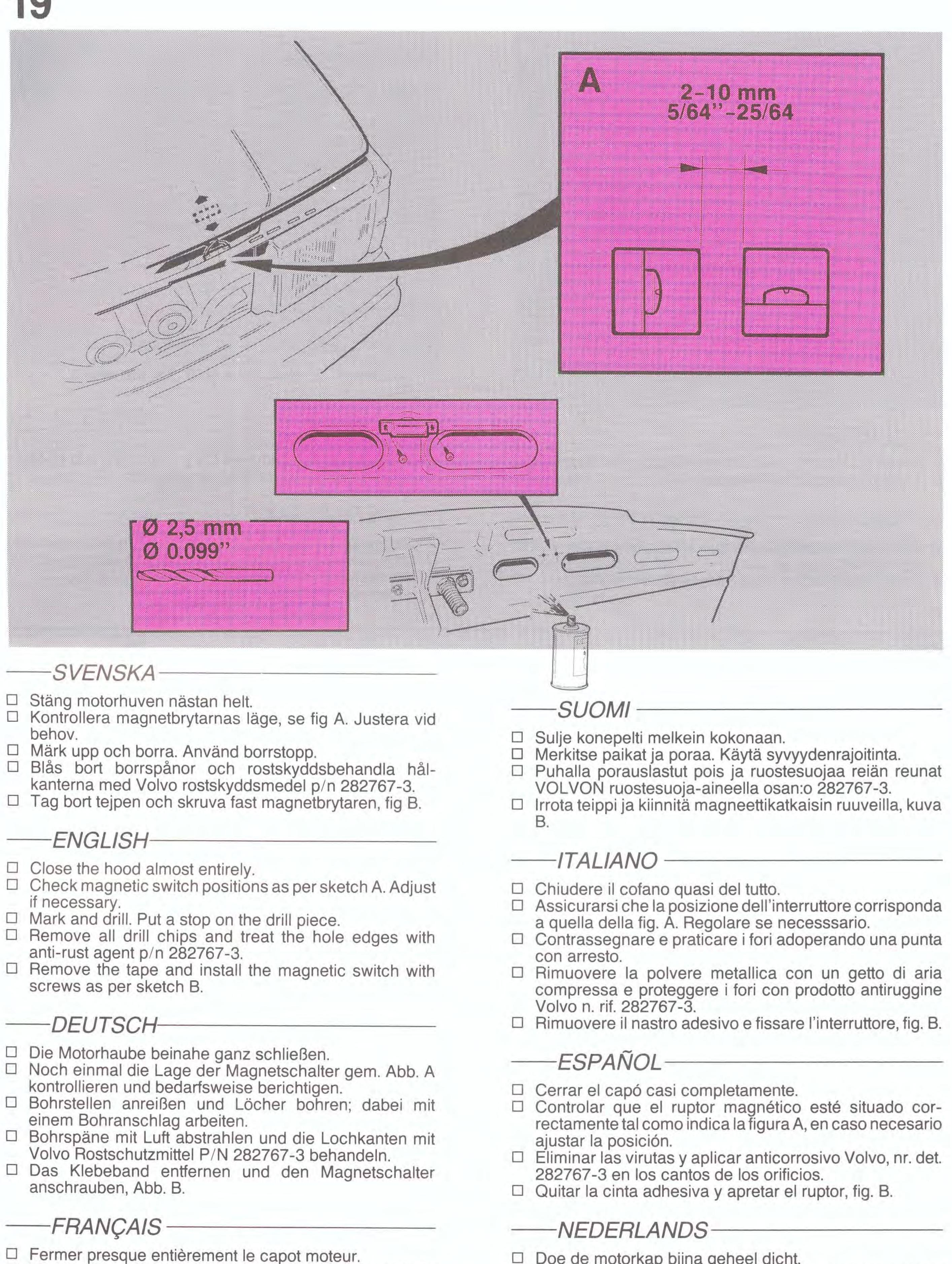
☐ Vérifier la position des rupteurs magnétiques, voir la figure A. Ajuster si nécessaire.
