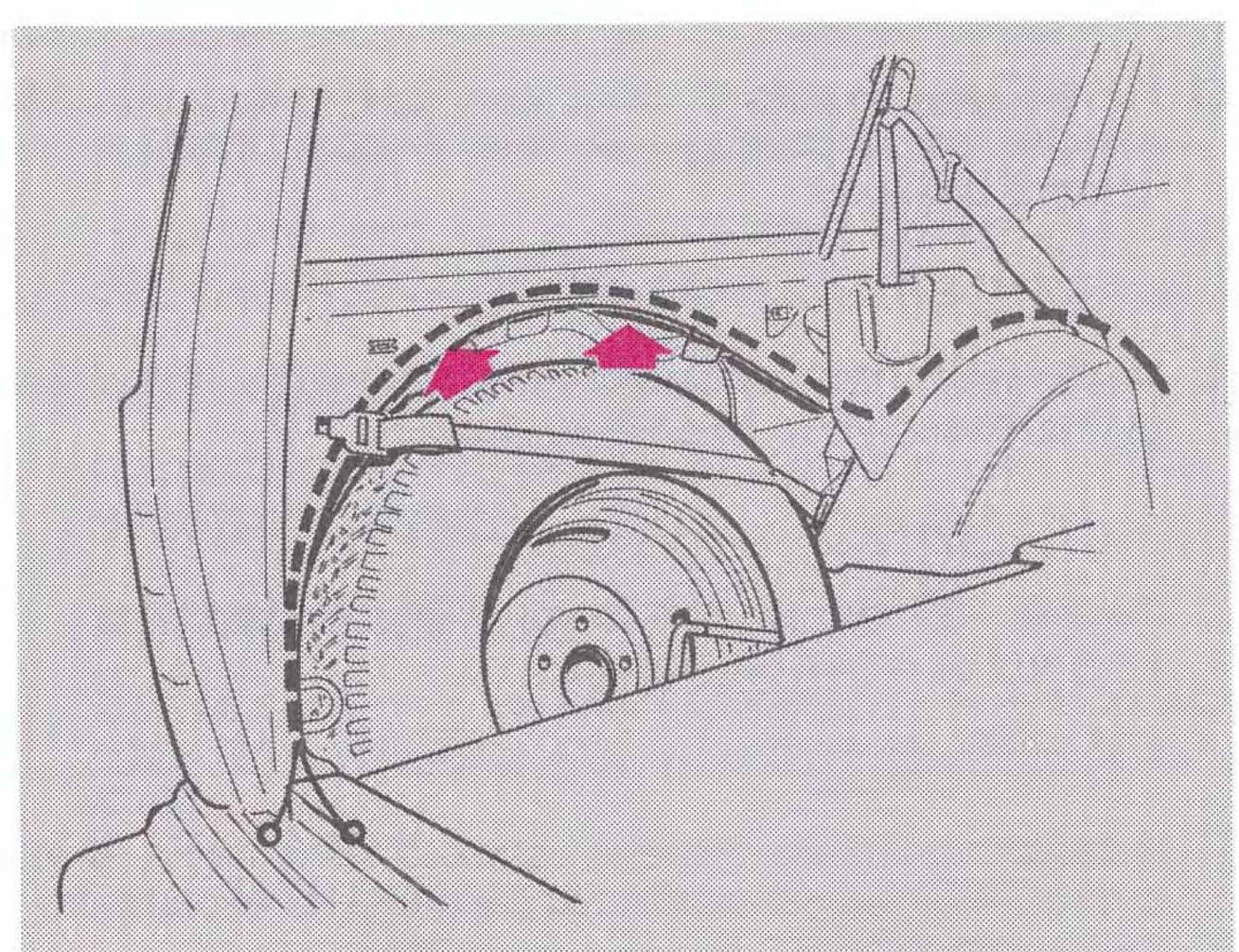
☐ Klamma ledningarna med buntband till befintlig ledningsmatta.
