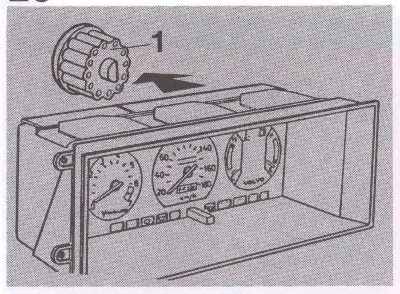
Ta bort det runda 12-poliga kontaktstycket (1) från kombiinstrumentet.
