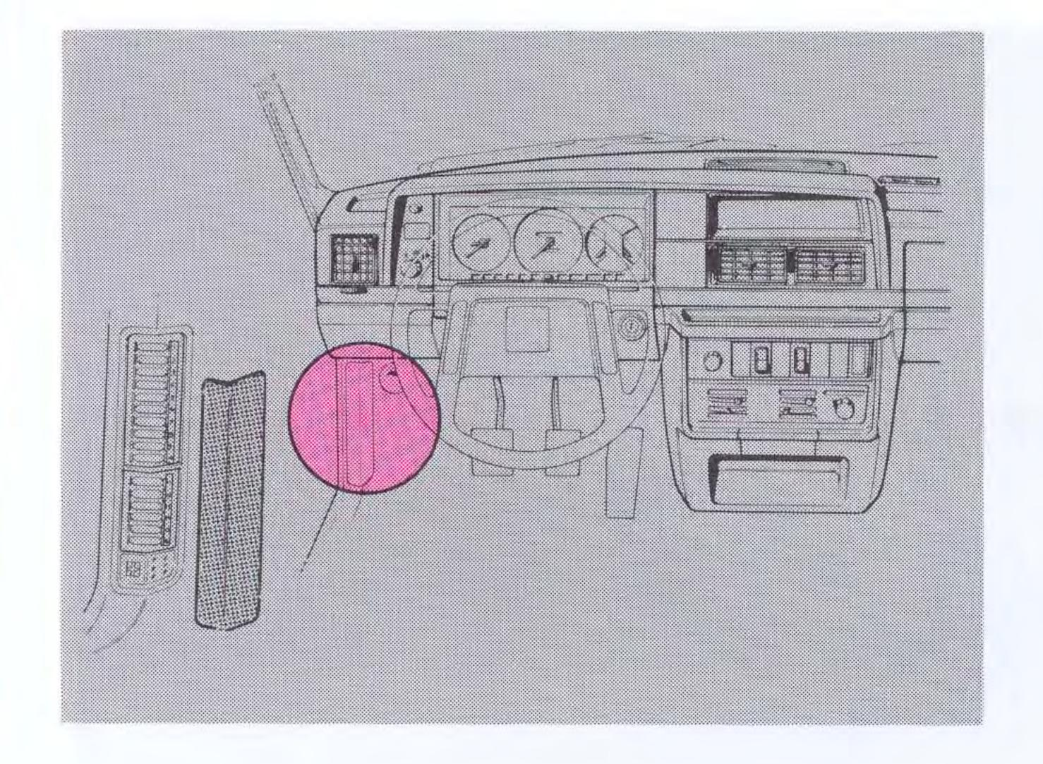
☐ Tag bort panelen över säkringshållaren och vik ut panelerna vid A-stolparna.
