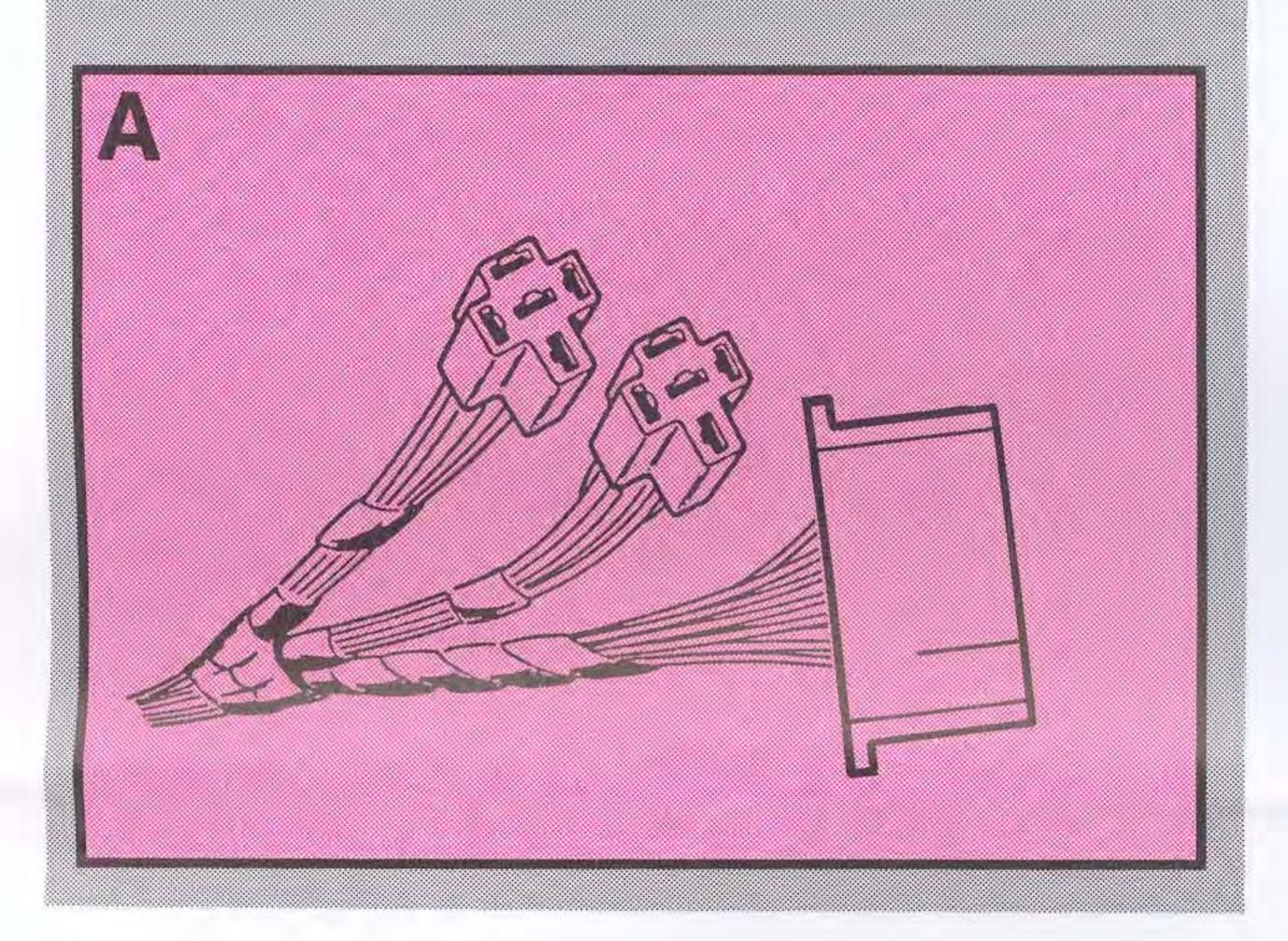
Drag ledningsmattan enligt figur. Lossa tejpen om ledningsmattan tills lämplig längd erhålls.
