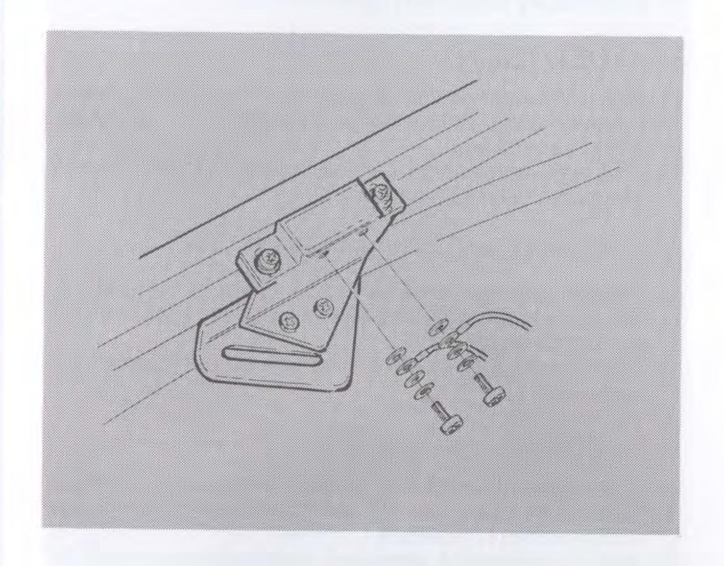
Anslut ledningarna till magnetbrytaren.
