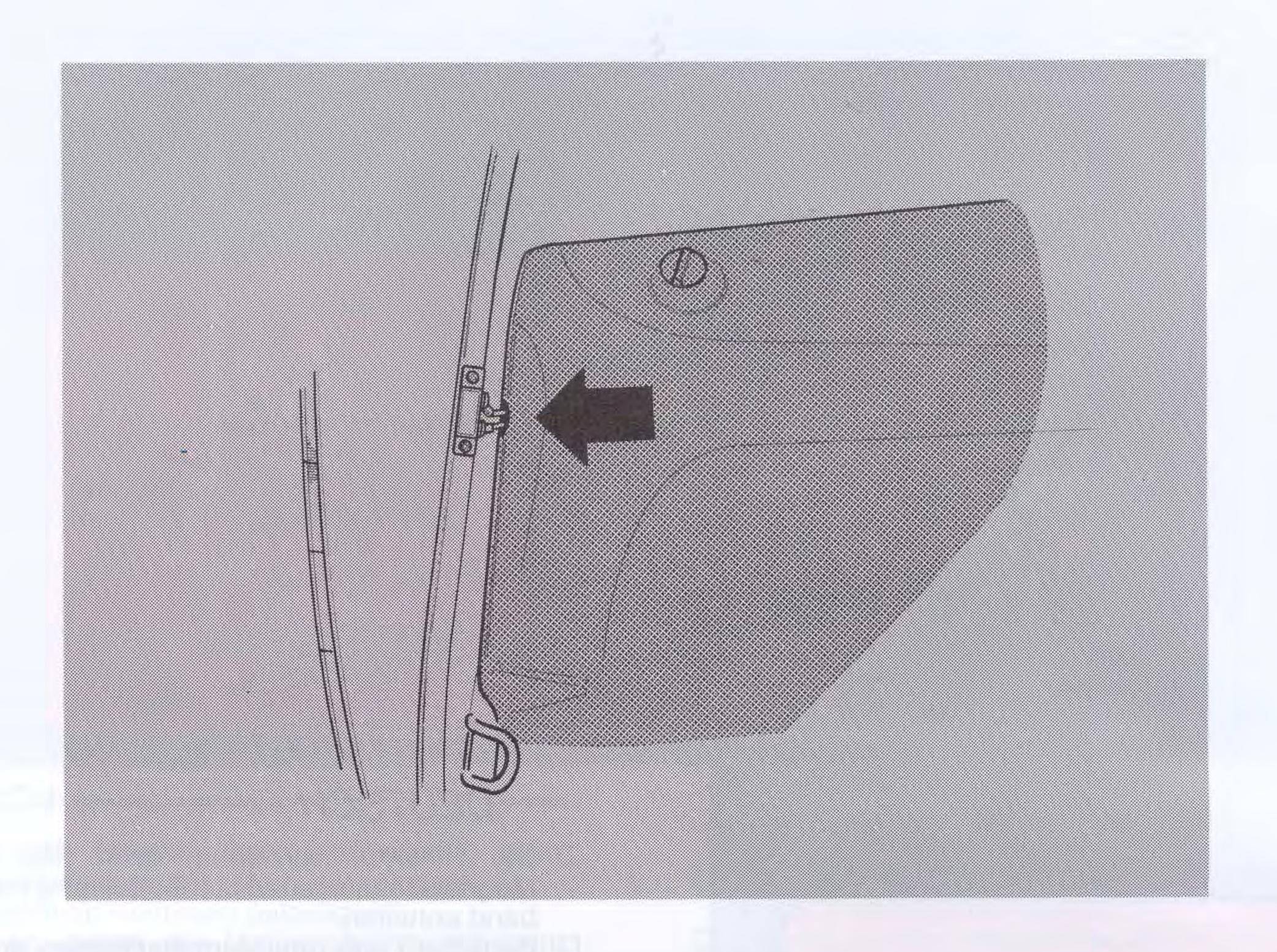
☐ Håll täckpanelen för reservhjulet på plats. Märk ut och fila till ett urtag för ledningarna.
