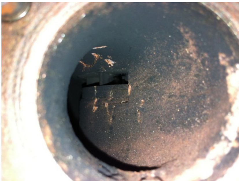
Figur 8: Eksempel, nærbilde av skade i turboinnløp som følge av for høy effekt
