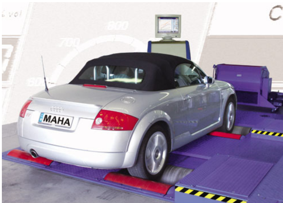
Figur 7: MAHA LPS 3000 dynamometer for kjøretøy inntil 2,5 tonn aksellast
