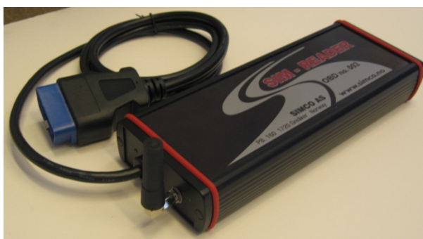
Figur 10: Sim-Reader fra SIMCO AS for avlesing av ECU-parametre
